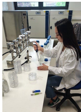
Slika 8. Nacijepijvanje uzoraka vode na mikrobiološke hranjive podloge
