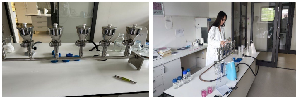
Slika 9. Aparatura i postupak membranske filtracije uzoraka vode za određivanje ukupnih koliforma
