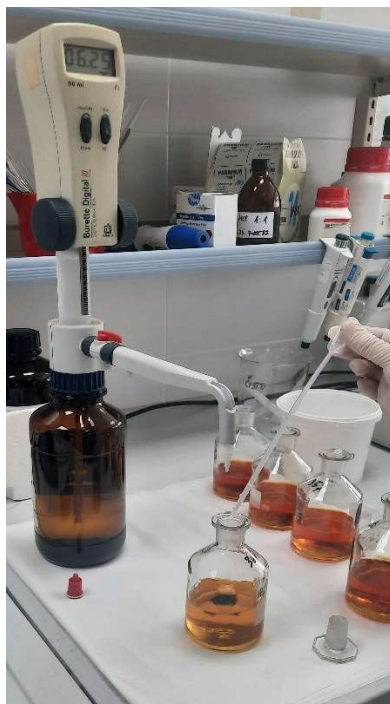
Slika 24 Dodatak indikatora i titracija
