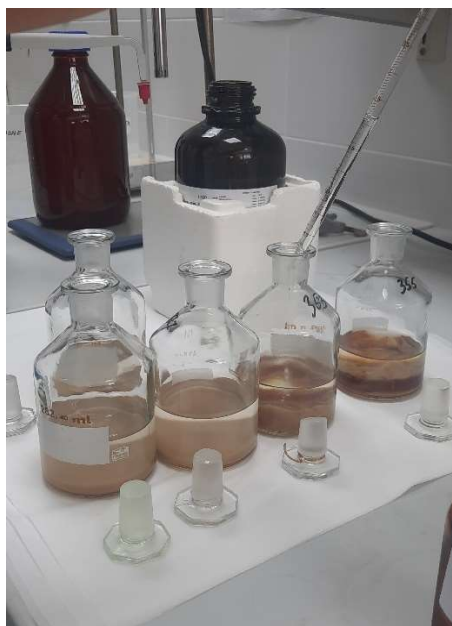
Slika 23 Dodatak sumporne kiseline u Winkler boce
