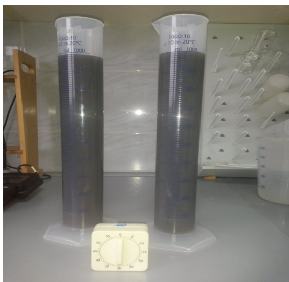
Slika 3 Postavljena aparatura za mjerenje brzine taloženja
