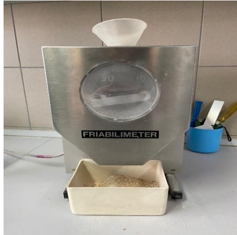
Slika 10. Friabilimetar-uređaj za mjerenje krhkosti ili lomljivosti
