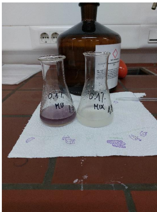
Slika 10 Određivanje peroksidnog broja u ulju
