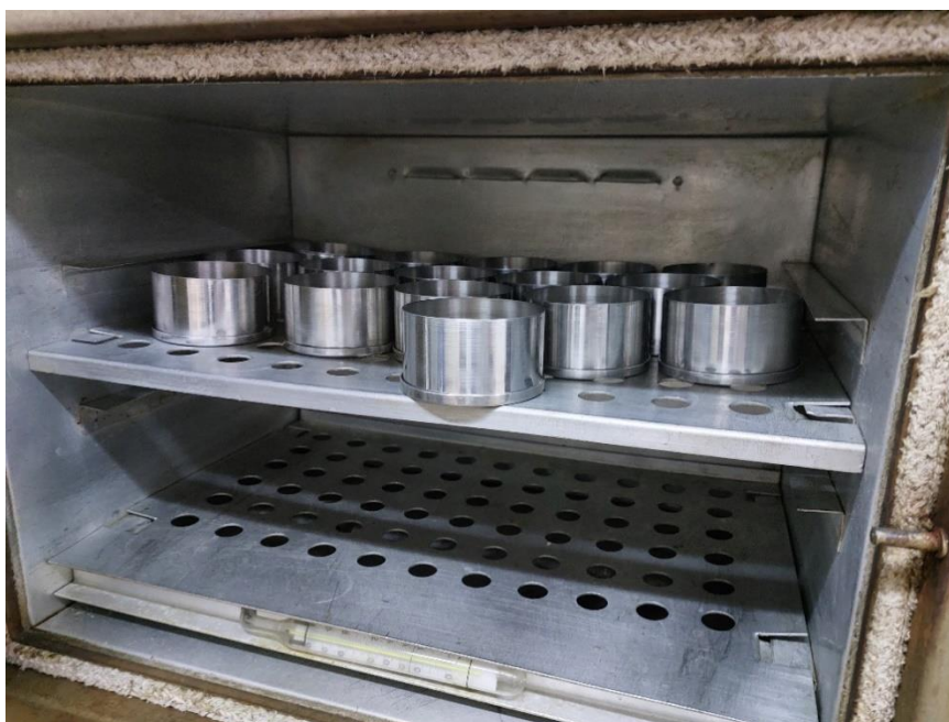
Slika 9 Posudice s uzorcima u sušioniku
