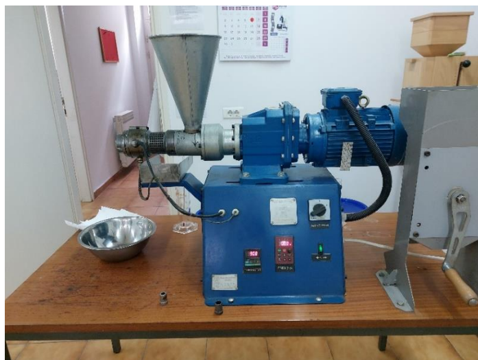
Slika 5 Kontinuirana pužna preša
