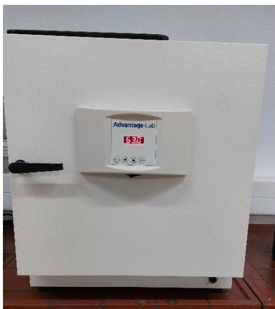
Slika 12 Sušionik zagrijan na 63 °C za provedbu testa
