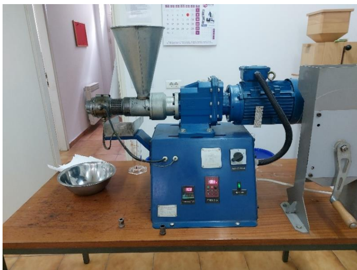
Slika 5 Kontinuirana pužna preša
