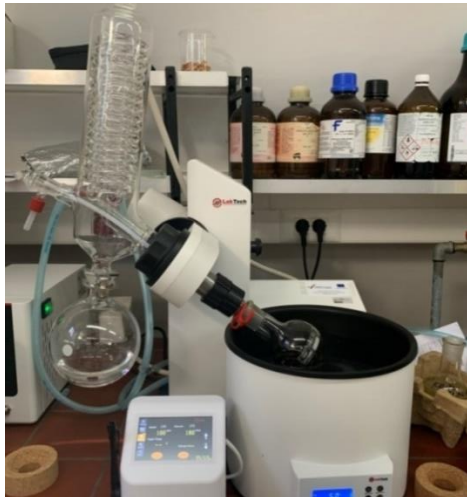
Slika 17 Otparavanje etanola iz tinktura na rotavaporu radi dobivanja ekstrakata
