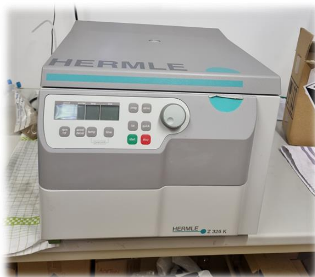
Slika 13 Centrifuga (Z 326 K, Hermle Labortechnik GmbH, Njemačka)
