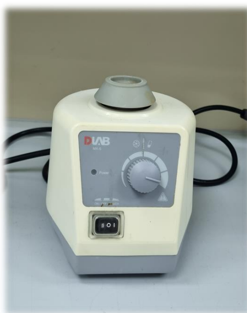
Slika 9 Vorteks (Vortex MX-S, DLAB Scientific, Kina)
