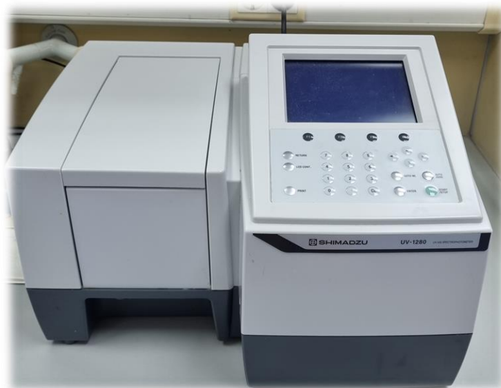
Slika 14 Spektrofotometar (UV-1280 UV-VIS Spectrophotometer, Shimadzu, Japan)
