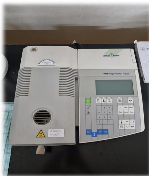
Slika 11 Analizator vlage (HR-73, Mettler Toledo)
