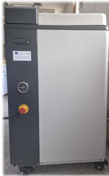
Slika 6 Autoklav (ASTELL AMA270, Kent, Ujedinjeno Kraljevstvo)
