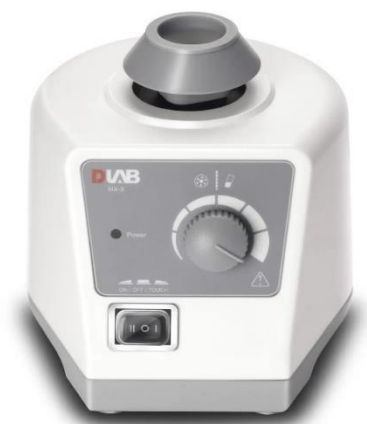
Slika 5 Vortex miješalica (Vortex MX-S, DLAB Scientific, Kina)
