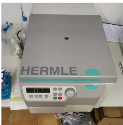
Slika 8 Centrifuga (Z 326 K, Hermle Labortechnik GmbH, Njemačka)
