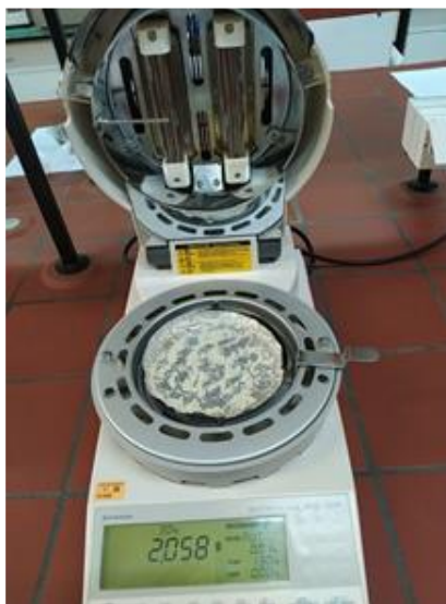
Slika 3 Uređaj za mjerenje vlage pomoću infracrvenog zračenja.
