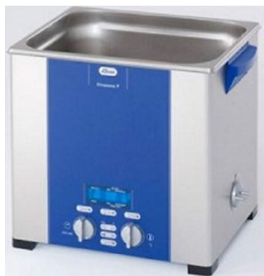
Slika 6 Ultrazvučna kupelj Elmasonic P 120 H, Elma
