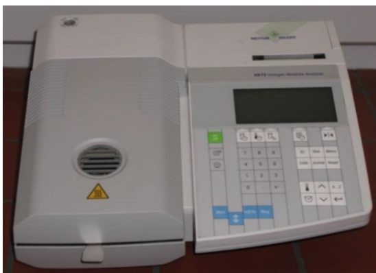
Slika 8 Analizator vlage Mettler Toledo HR73
