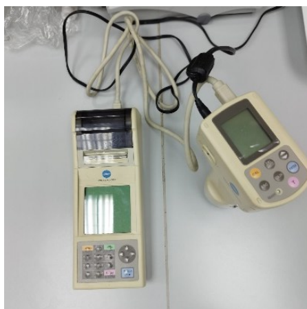
Slika 12. Kolorimetar (Chroma Meter CR-400, Konica Minolta, USA)
