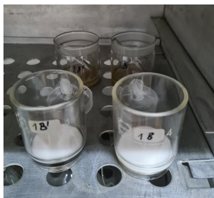
Slika 20 Određivanje vlage i netopljivih nečistoća u ulju
