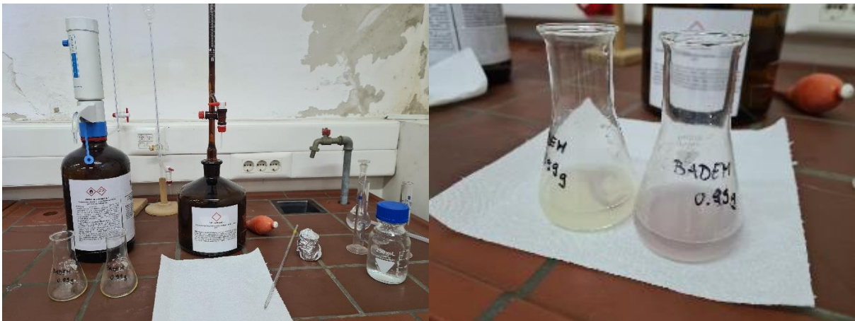
Slika 21 Određivanje peroksidnog broja u ulju (po Wheeleru)
