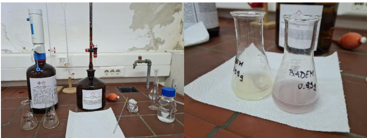
Slika 21 Određivanje peroksidnog broja u ulju (po Wheeleru)
