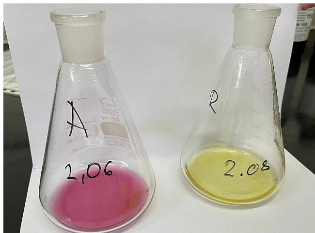
Slika 8 Promjena boje prilikom titracije za određivanje SMK (Izvor: autor)
