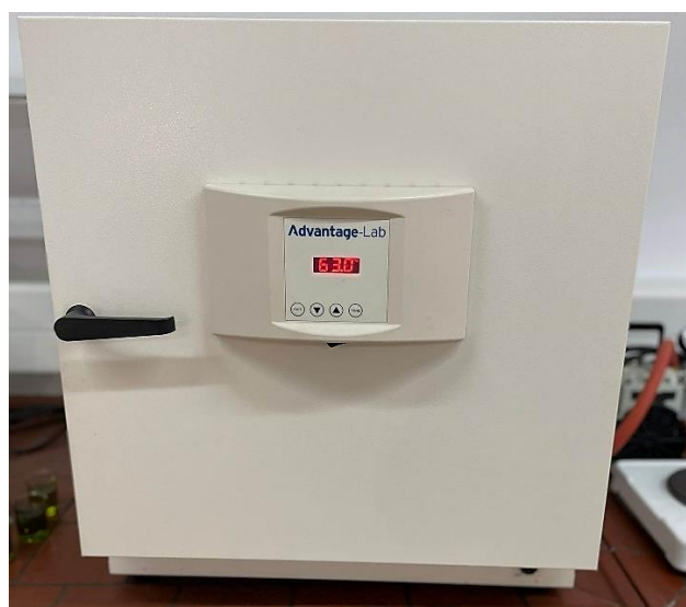
Slika 10 Sušionik zagrijan na 63 °C (Izvor: autor)
