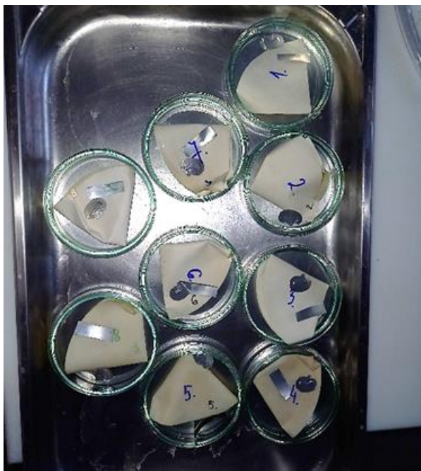
Slika 4. Pripremljeni uzorci za analizu sa ocijeđenim filter papirom, tijelom i poklopcem limenke (Izvor: autor)
