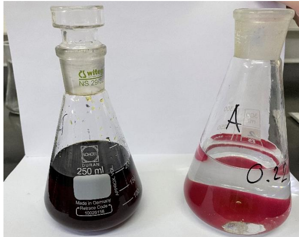
Slika 21 Promjena boje nakon titracije kod određivanja jodnog broja (Izvor: autor)
