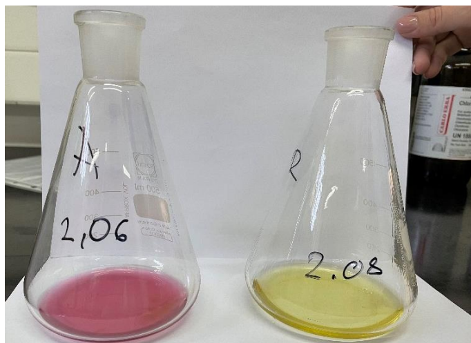
Slika 20 Promjena boje nakon titracije kod određivanja saponifikacijskog broja (Izvor: autor)
