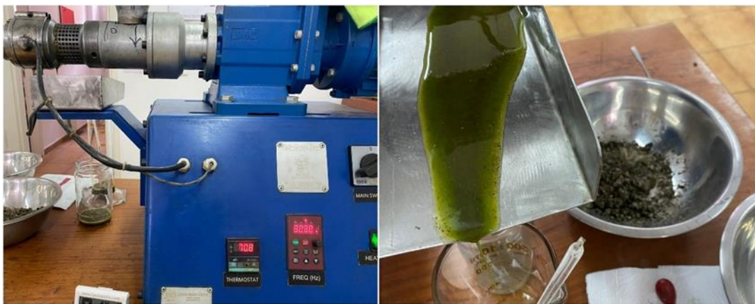
Slika 5 Dobivanje sirovog hladno prešanog ulja konoplje na kontinuiranoj pužnoj preši (Fotografirala: L. Spajić)
