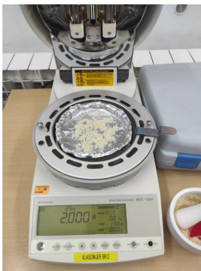
Slika 6. Određivanje udjela vlage u krekerima
