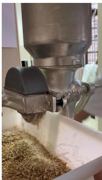
Slika 4 Mljevenje ječmenog slada na laboratorijskom mlinu (izvor: privatna arhiva)
