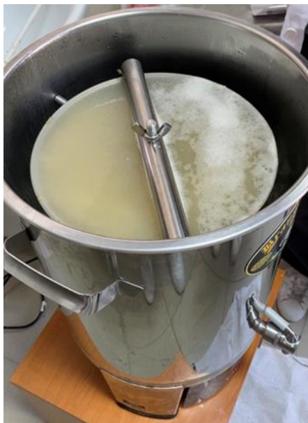
Slika 8 Prikaz prelijevanja sladovine pomoću pumpe (izvor: privatna arhiva)
