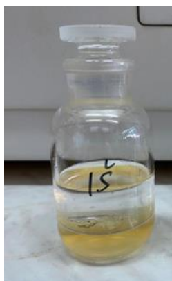
Slika 22 Pripremljeni uzorak piva za određivanje gorčine (izvor: privatna arhiva)
