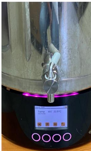
Slika 6 Prikaz kontrole temperature za ukomljavanje na uređaju Speidel Braumeister (izvor: privatna arhiva)
