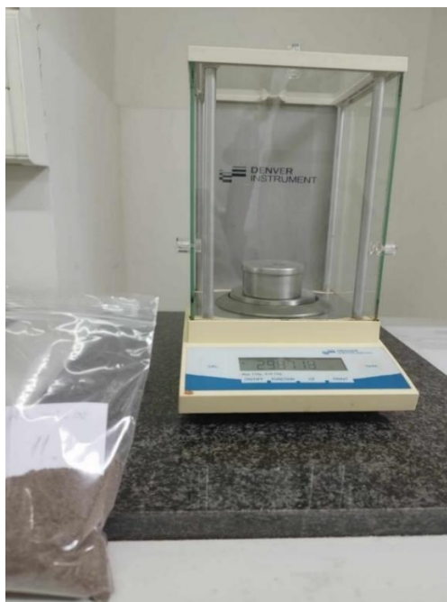
Slika 23 Postupak sušenja i vaganja sjemenki i pogače za određivanje udjela vode
