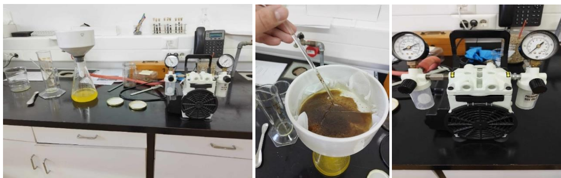
Slika 21 Proces filtracije sirovog ulja
