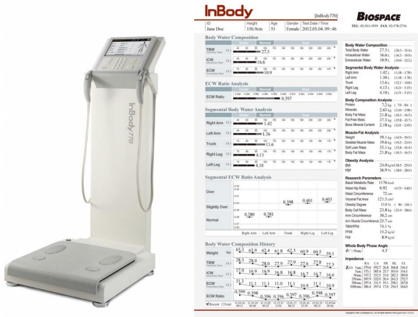
Slika 7 InBody770 analizator sastava (lijevo) i ogledni prikaz rezultata jediničnog mjerenja (desno) (Medical Centar)
