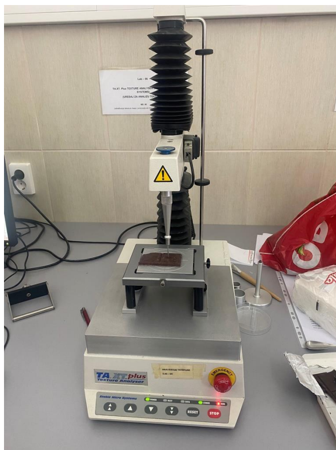
Slika 10 Uređaj za određivanje čvrstoće metodom penetracije TA.XT Texture Analyser
