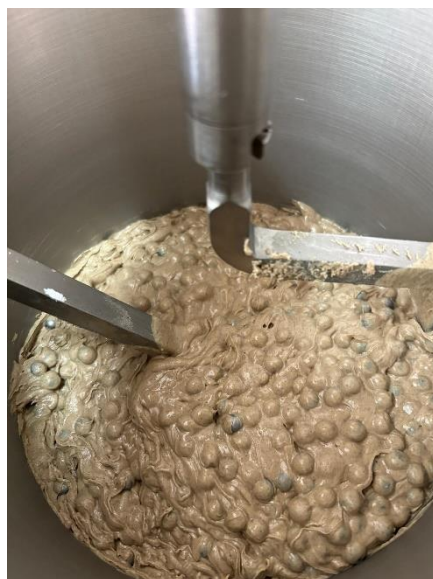
Slika 33 Unutrašnjost kugličnog mlina tijekom izrade mliječnog krem-proizvoda
