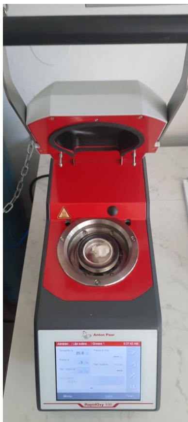
Slika 41 Uređaj za određivanje oksidacijske stabilnosti
