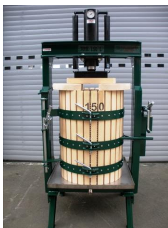
Slika 5 Preša za grožđe (Web 5)
