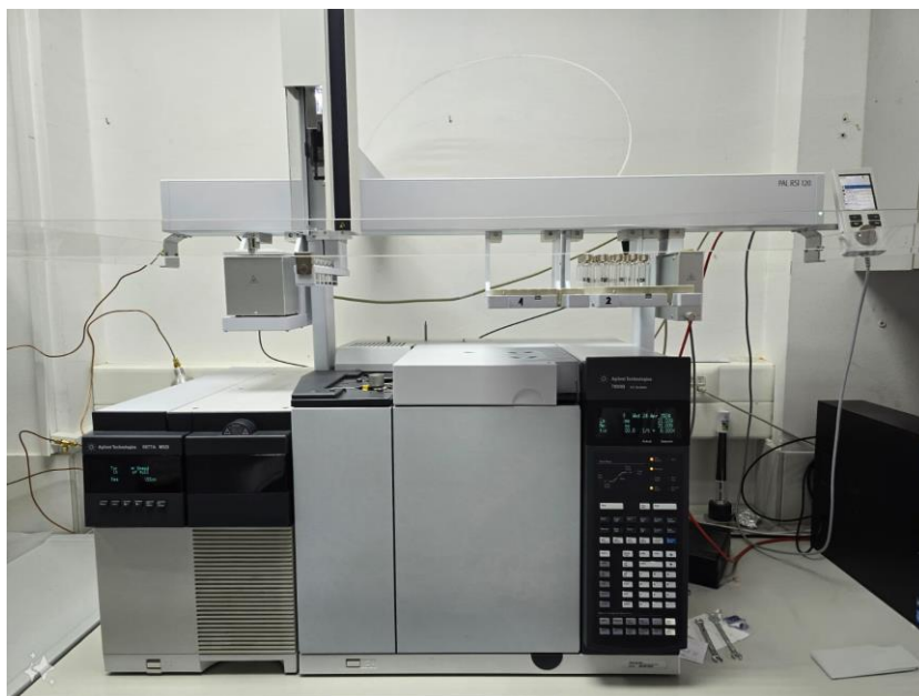
Slika 10 Plinski kromatograf Agilent 7890B s masenim detektorom Agilent 5977A
