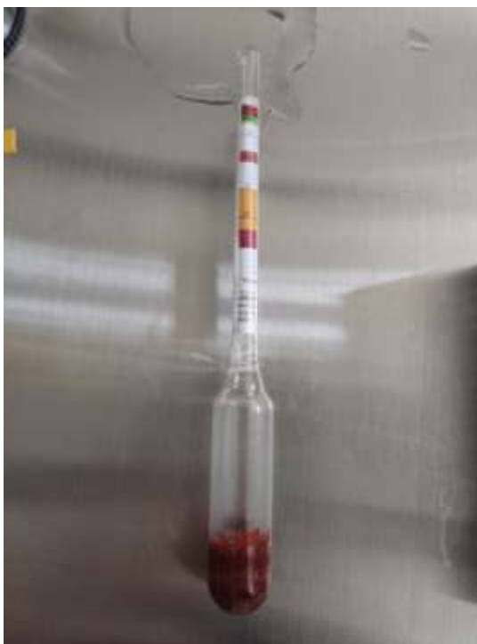
Slika 11 Mini – Browin saharometar
