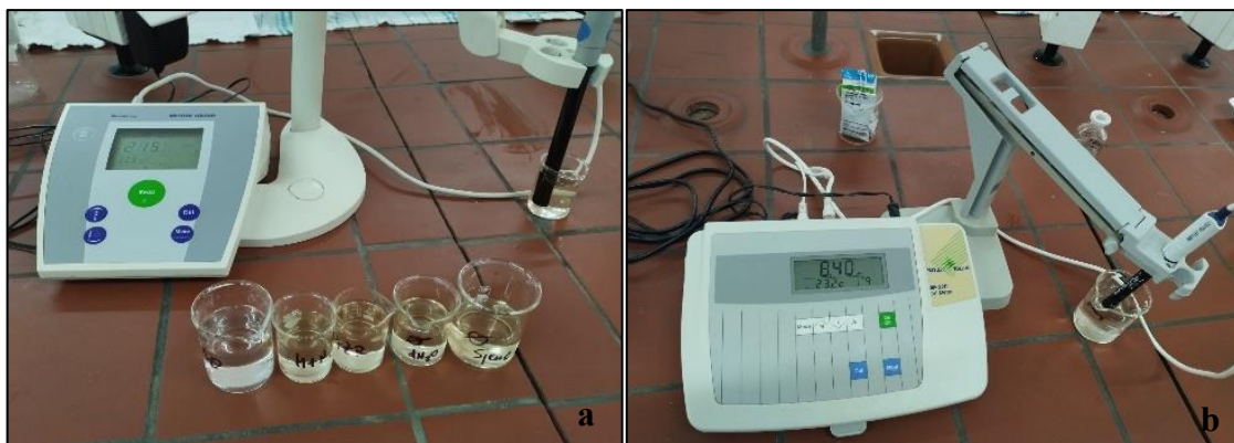
Slika 6 Prikaz mjerenja električne vodljivosti (a) i pH vrijednosti (b) otopina tretiranih različitim PAW postupcima.
