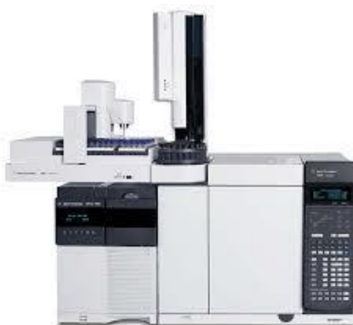
Slika 6 Plinski kromatograf s masenim detektorom (Web 3)
