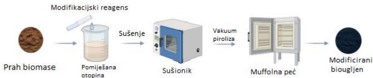
Slika 3 Postupak modifikacije biougljena prije procesa pirolize (prema Wu i sur. 2024)
