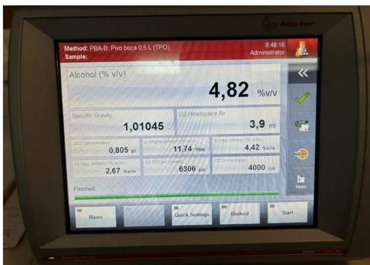
Slika 13 Prikaz dobivenih rezultata na uređaju za analizu piva DMA 4500 M (vlastita arhiva)
