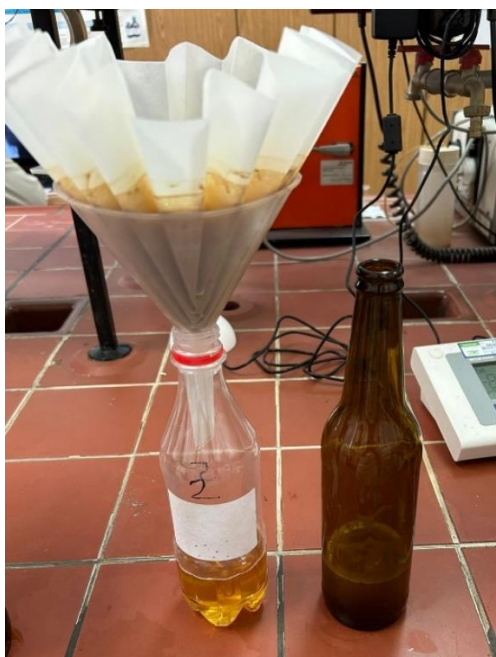
Slika 11 Filtracija piva uz filter papir i dijatomejskom zemljom (vlastita arhiva)
