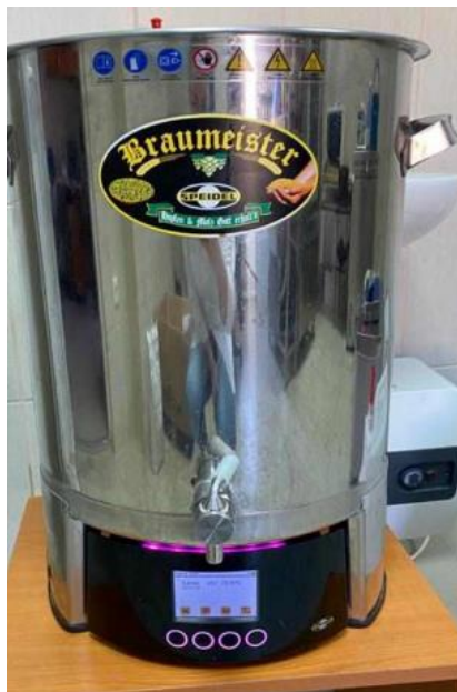
Slika 3 Speidel Braumeister uređaj za kuhanje piva (vlastita arhiva)
