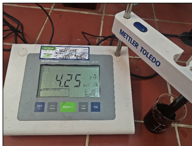
Slika 13 Mjerenje pH vrijednosti (izvor: privatna arhiva)
