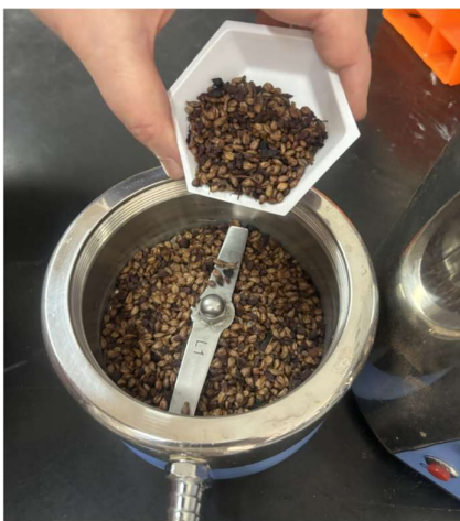
Slika 11 Postupak usitnjavanja sjemenki grožđa (Izvor: autor)
