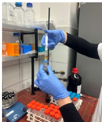
Slika 22 Filtracija uzoraka s PTFE filterima (Izvor: autor)
