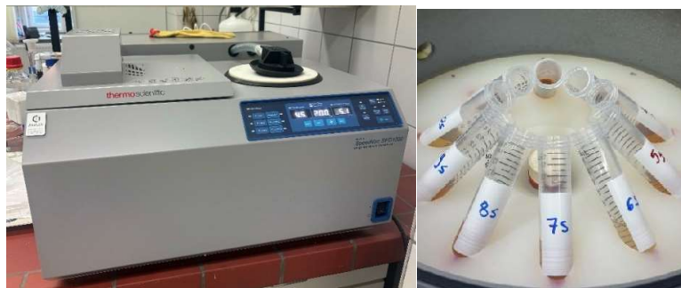
Slika 18 Uparavanje u uređaju SpeedVac (Izvor: autor)
