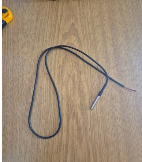
Slika 11 DS18B20 u zaštitnoj košuljici (osobna arhiva)
