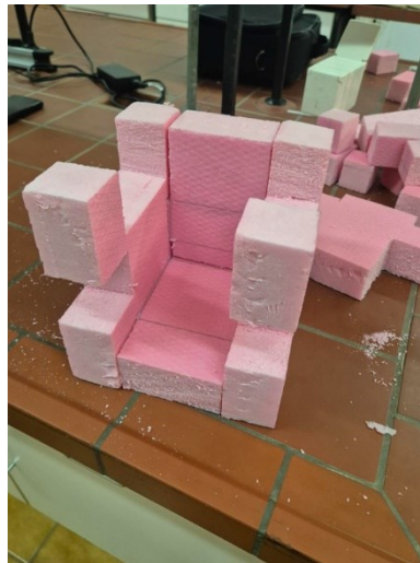
Slika 15 Prvi model komore ručno rezan (osobna arhiva)
