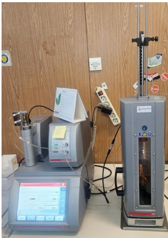
Slika 13 Uređaj DMA 4500 M za analiziranje piva (izvor: vlastita arhiva)
