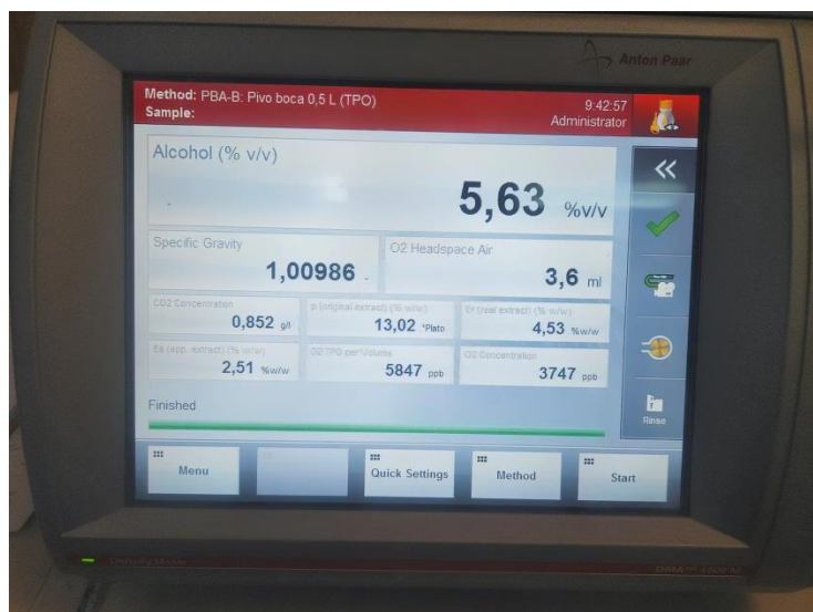
Slika 14 Prikaz rezultata izmjerenih na uređaju DMA 4500 M (izvor: vlastita arhiva)
