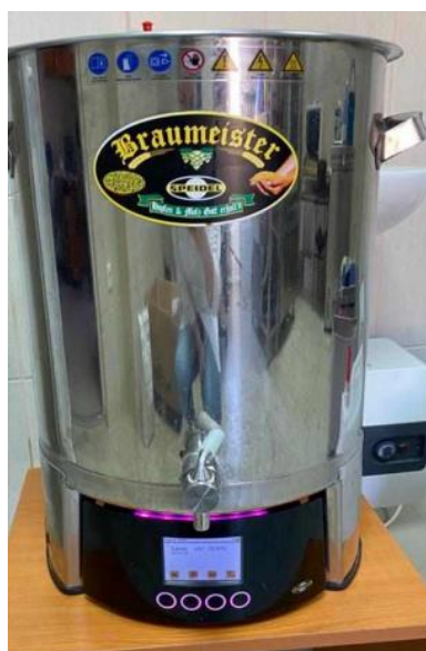
Slika 4 Speidel Braumeister uređaj za kuhanje piva (Vlastita arhiva)
