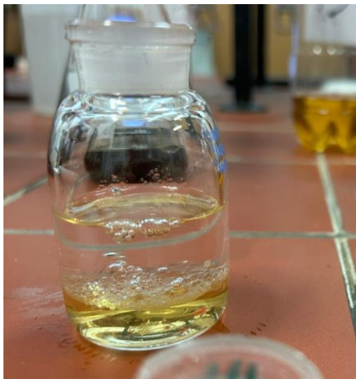
Slika 14 Pripremljeni uzorak za određivanje gorčine podijeljen u 2 sloja (Vlastita arhiva)
