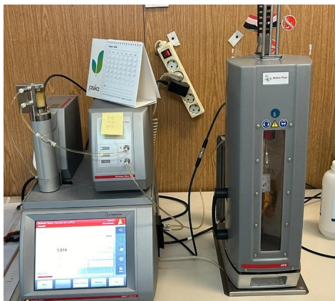
Slika 10 Uređaj za analizu piva DMA 4500 M proizvođača Anton Paar (Vlastita arhiva)
