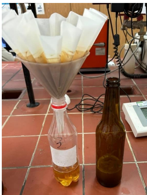
Slika 9 Filtracija piva uz filter papir i dijatomejskom zemljom (Vlastita arhiva)
