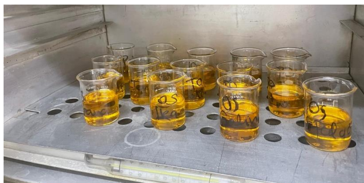
Slika 29 Određivanje oksidacijske stabilnosti ulja
