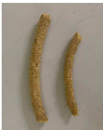
Slika 5 Pogača dobivena prešanjem s nastavkom za izlaz pogače D6 i D8
