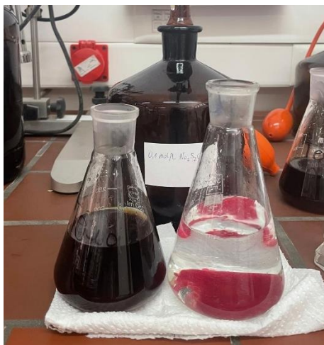
Slika 26 Promjena boje nakon titracije kod određivanja jednog broja
