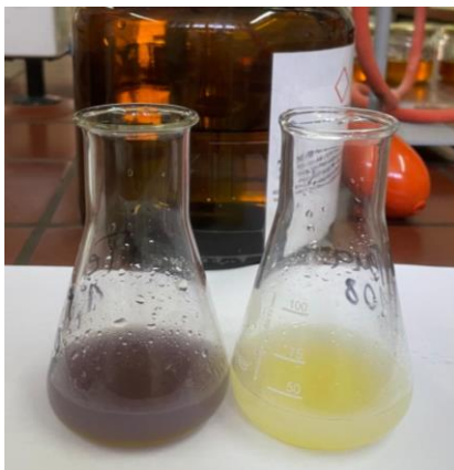
Slika 19 Promjena boje ulja kod određivanja Pbr-a
