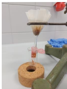
Slika 8 Postupak filtracije ekstrakta biljnog materijala u eutektičkom otapalu
