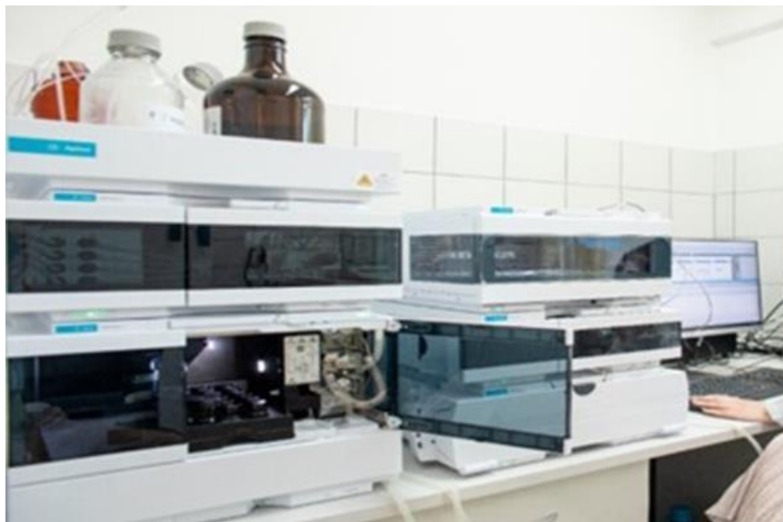
Slika 6 Visoko djelotvoran tekućinski kromatograf s detektorom s nizom dioda (Aladić, 2015)
