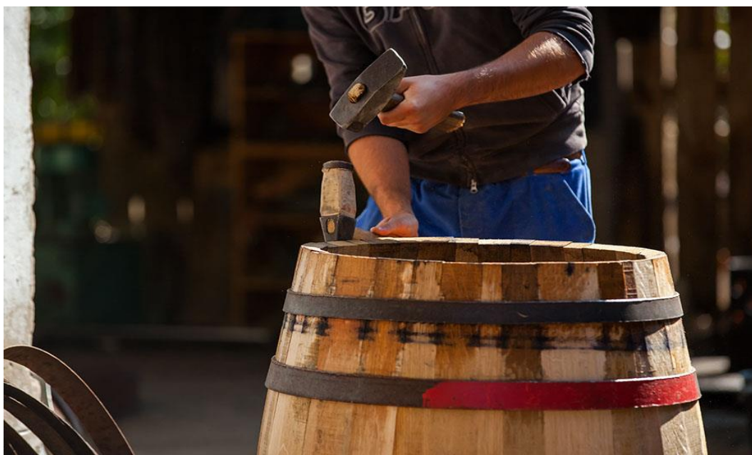
Slika 5 Navlačenje obruča ( Web 5 )
