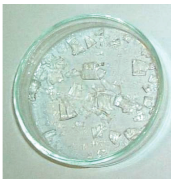
Slika 2. Izgled silikatnog gela nakon sušenja u vakuum sušioniku, 24 sata pri 60 °C Fig. 2. The appearance of silica gel after drying in a vacuum dryer, 24 hours at 60 °C
