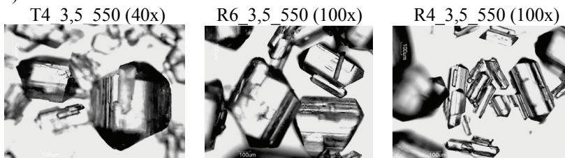
Slika 1. a) Širina metastabilne zone i promjena koncentracije; b) Funkcija gustoće raspodjele i kumulativna funkcija raspodjele; c) Mikroskopska analiza kristala glicina dobivenih korištenjem turbinskog miješala sa 4 lopatice i Rushtonovih miješala sa 4 i 6 lopatica ( Re=43\ 062 )
