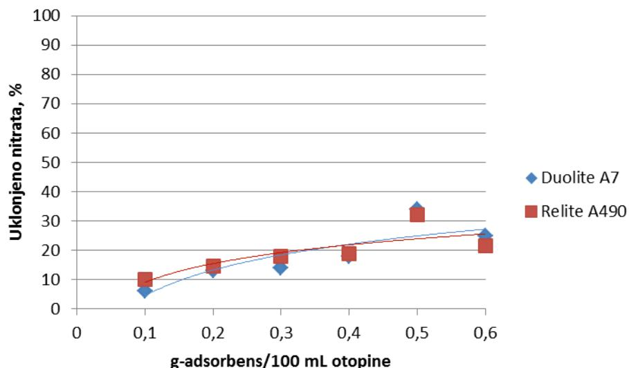
**Slika 7.** Utjecaj mase ionskog izmjenivača na učinkovitost uklanjanja nitrata iz vodene otopine početne koncentracije  $10 \text{ mg/l N-NO}_3^-$  pri vremenu 30 min
