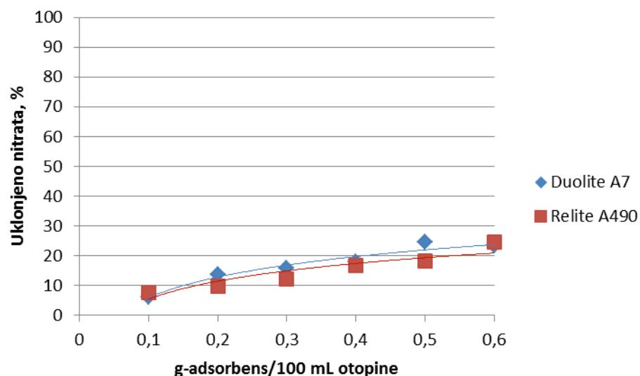
Slika 13. Utjecaj mase ionskog izmjenjivača na učinkovitost uklanjanja nitrata iz vodene otopine početne koncentracije 50 mg/l N-NO<sub>3</sub><sup>-</sup> pri vremenu 15 min
