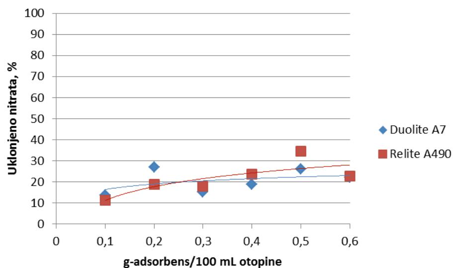
Slika 14. Utjecaj mase ionskog izmjenjivača na učinkovitost uklanjanja nitrata iz vodene otopine početne koncentracije 50 mg/l N-NO<sub>3</sub><sup>-</sup> pri vremenu 30 min
