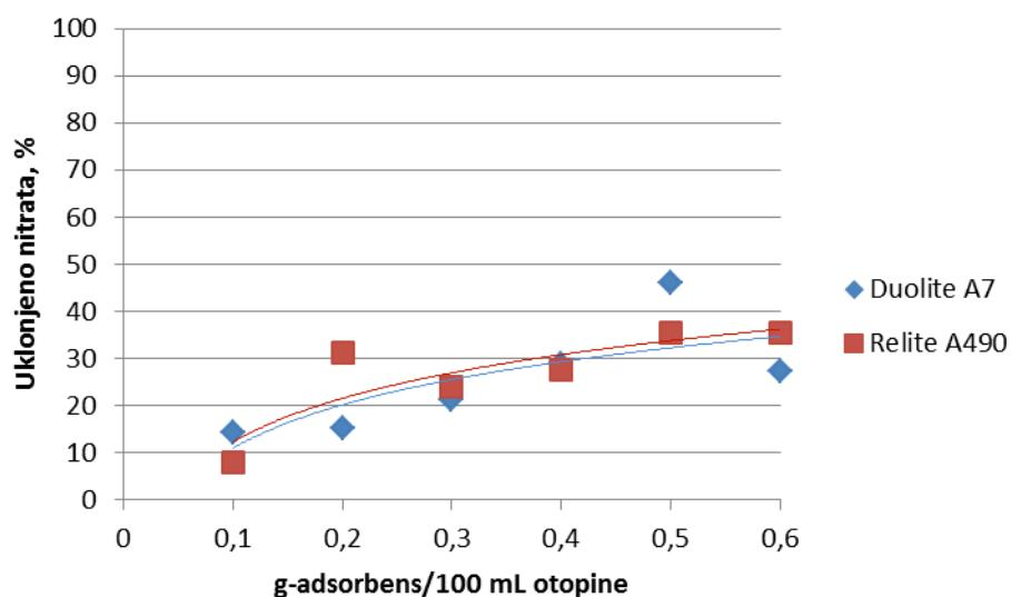
**Slika 8.** Utjecaj mase ionskog izmjenivača na učinkovitost uklanjanja nitrata iz vodene otopine početne koncentracije  $10 \text{ mg/l N-NO}_3^-$  pri vremenu 60 min
