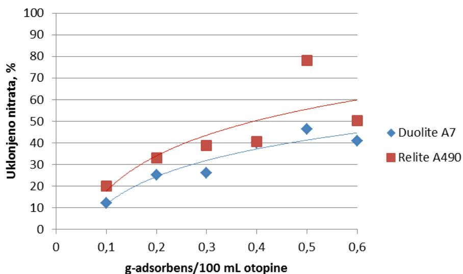
**Slika 16.** Utjecaj mase ionskog izmjenjivača na učinkovitost uklanjanja nitrata iz vodene otopine početne koncentracije 50 mg/l N-NO<sub>3</sub><sup>-</sup> pri vremenu 120 min
