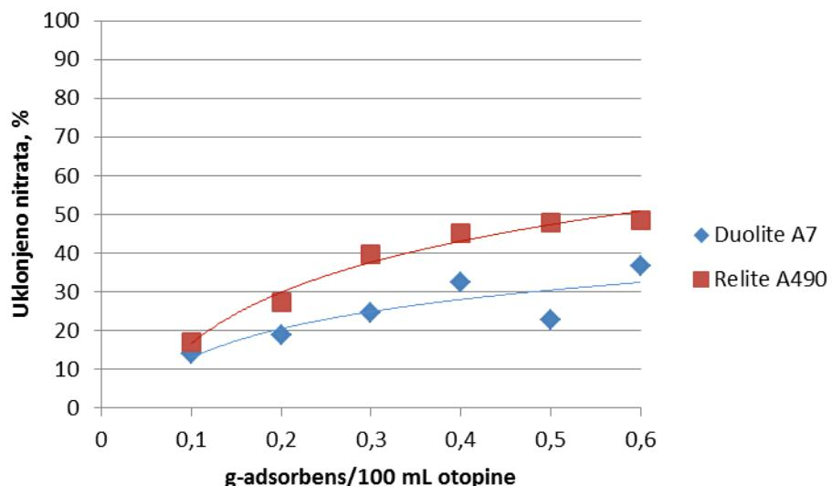
**Slika 24.** Utjecaj mase ionskog izmjenjivača na učinkovitost uklanjanja nitrata iz vodene otopine početne koncentracije 100 mg/l N-NO<sub>3</sub><sup>-</sup> pri vremenu 240 min
