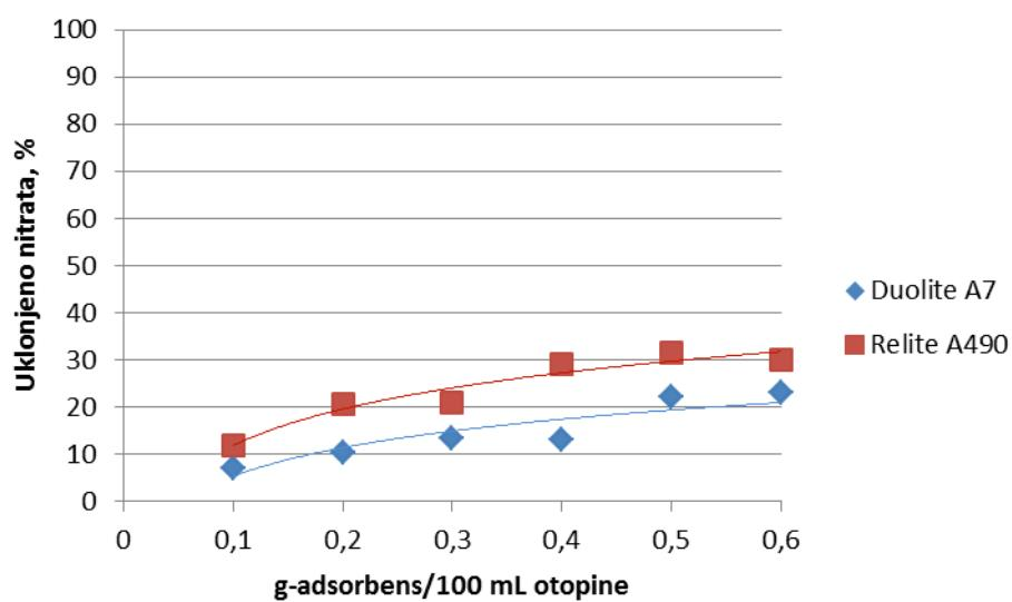
**Slika 21.** Utjecaj mase ionskog izmjenjivača na učinkovitost uklanjanja nitrata iz vodene otopine početne koncentracije 100 mg/l N-NO<sub>3</sub><sup>-</sup> pri vremenu 30 min
