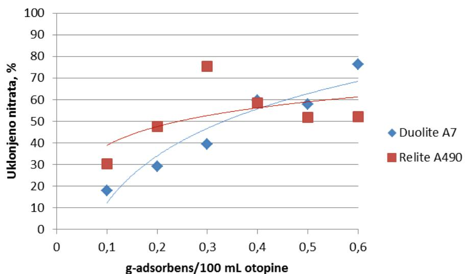
**Slika 10.** Utjecaj mase ionskog izmjenivača na učinkovitost uklanjanja nitrata iz vodene otopine početne koncentracije 10 mg/l N-NO<sub>3</sub><sup>-</sup> pri vremenu 240 min
