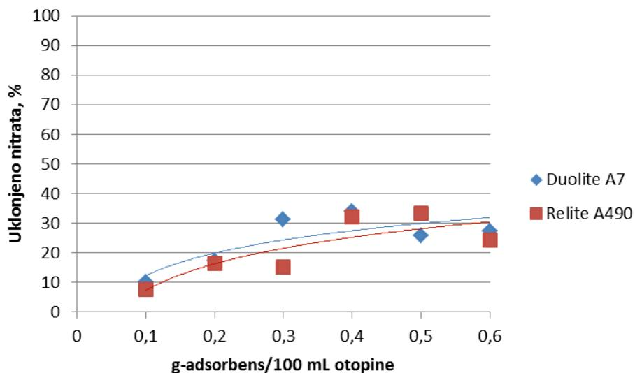
**Slika 15.** Utjecaj mase ionskog izmjenjivača na učinkovitost uklanjanja nitrata iz vodene otopine početne koncentracije 50 mg/l N-NO<sub>3</sub><sup>-</sup> pri vremenu 60 min
