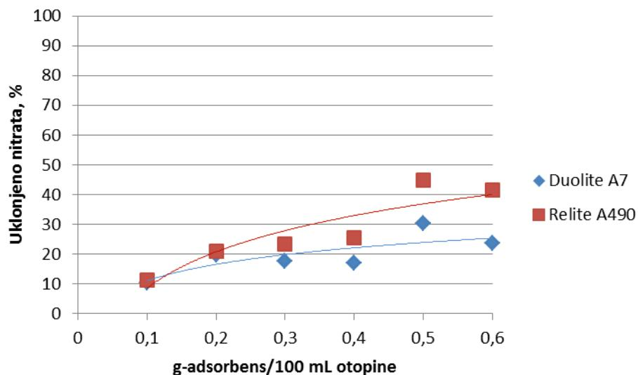
**Slika 22.** Utjecaj mase ionskog izmjenjivača na učinkovitost uklanjanja nitrata iz vodene otopine početne koncentracije 100 mg/l N-NO<sub>3</sub><sup>-</sup> pri vremenu 60 min
