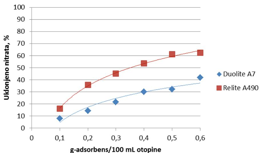
**Slika 25.** Utjecaj mase ionskog izmjenjivača na učinkovitost uklanjanja nitrata iz vodene otopine početne koncentracije 100 mg/l N-NO<sub>3</sub><sup>-</sup> pri vremenu 360 min
