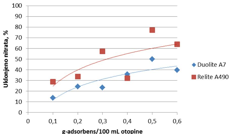
**Slika 9.** Utjecaj mase ionskog izmjenivača na učinkovitost uklanjanja nitrata iz vodene otopine početne koncentracije 10 mg/l N-NO<sub>3</sub><sup>-</sup> pri vremenu 120 min
