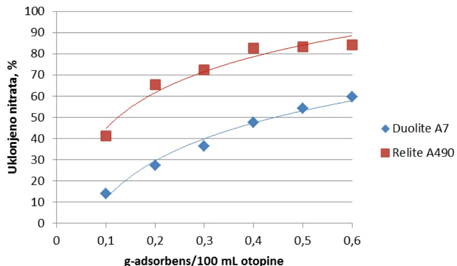
**Slika 19.** Utjecaj mase ionskog izmjenjivača na učinkovitost uklanjanja nitrata iz vodene otopine početne koncentracije 50 mg/l N-NO<sub>3</sub><sup>-</sup> pri vremenu 24 h
