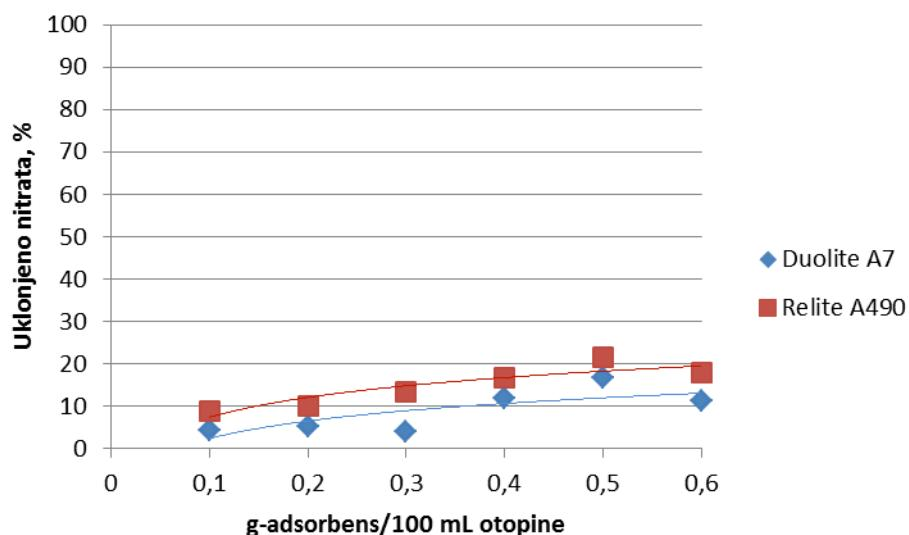
**Slika 20.** Utjecaj mase ionskog izmjenjivača na učinkovitost uklanjanja nitrata iz vodene otopine početne koncentracije 100 mg/l N-NO<sub>3</sub><sup>-</sup> pri vremenu 15 min
