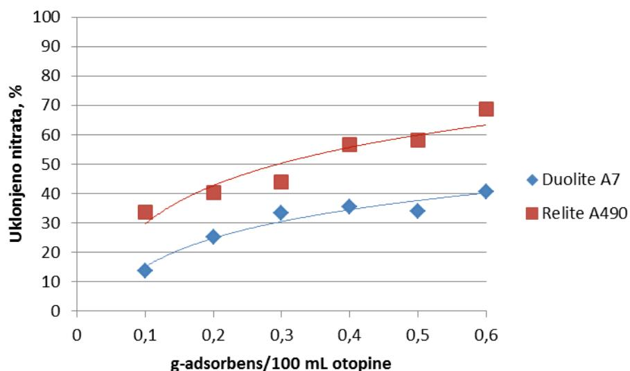
**Slika 18.** Utjecaj mase ionskog izmjenjivača na učinkovitost uklanjanja nitrata iz vodene otopine početne koncentracije 50 mg/l N-NO<sub>3</sub><sup>-</sup> pri vremenu 360 min
