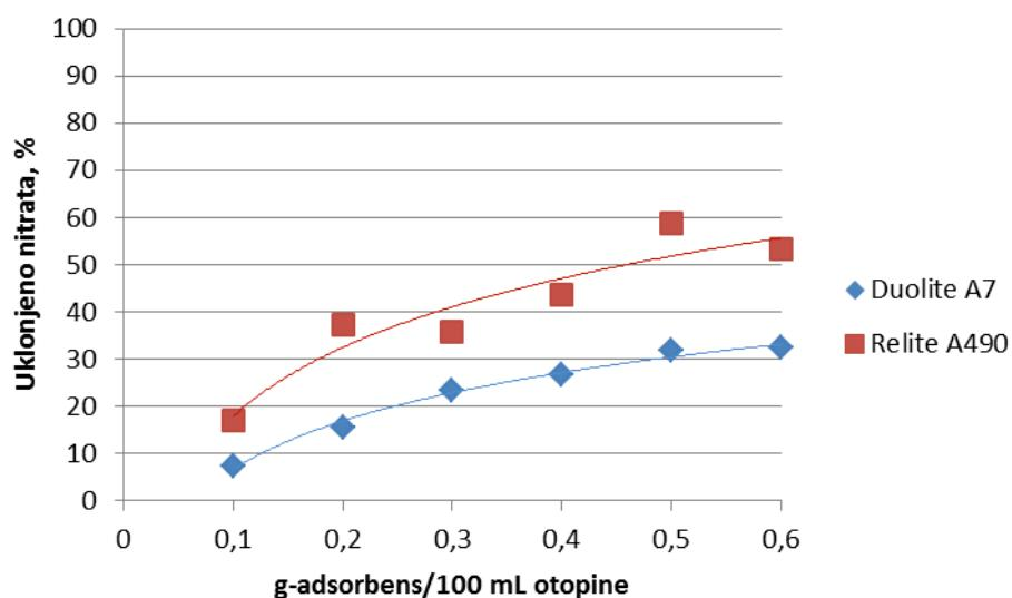
**Slika 23.** Utjecaj mase ionskog izmjenjivača na učinkovitost uklanjanja nitrata iz vodene otopine početne koncentracije 100 mg/l N-NO<sub>3</sub><sup>-</sup> pri vremenu 120 min
