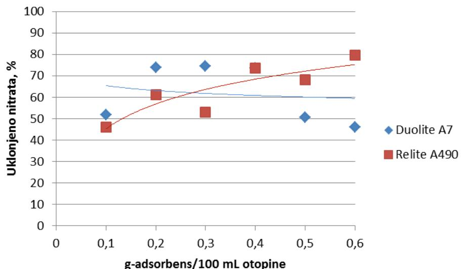
**Slika 11.** Utjecaj mase ionskog izmjenjivača na učinkovitost uklanjanja nitrata iz vodene otopine početne koncentracije 10 mg/l N- $\text{NO}_3^-$  pri vremenu 360 min
