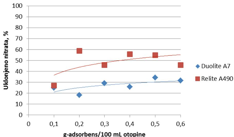
**Slika 17.** Utjecaj mase ionskog izmjenjivača na učinkovitost uklanjanja nitrata iz vodene otopine početne koncentracije 50 mg/l N-NO<sub>3</sub><sup>-</sup> pri vremenu 240 min
