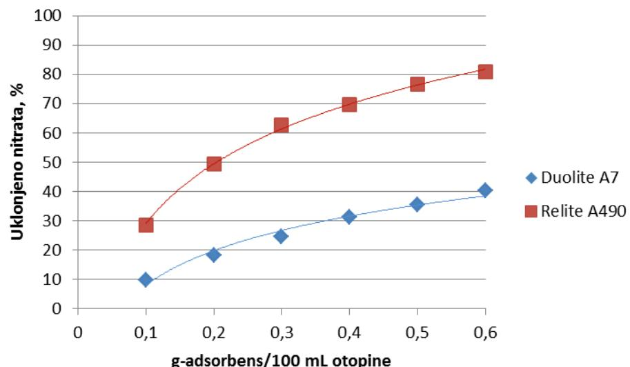
**Slika 26.** Utjecaj mase ionskog izmjerenivača na učinkovitost uklanjanja nitrata iz vodene otopine početne koncentracije 100 mg/l N-NO<sub>3</sub><sup>-</sup> pri vremenu 24 h
