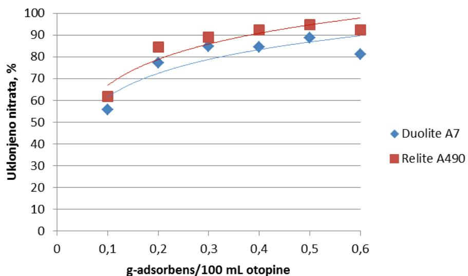
**Slika 12.** Utjecaj mase ionskog izmjenjivača na učinkovitost uklanjanja nitrata iz vodene otopine početne koncentracije 10 mg/l N- $\text{NO}_3^-$  pri vremenu 24 h
