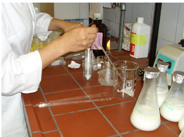
Slika 15 Uzimanje uzorka za mjerenje pH vrijednosti u sterilnim uvjetima
