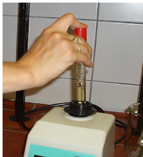
Slika 21 Homogenizacija uzorka (agar + patogena bakterija)
