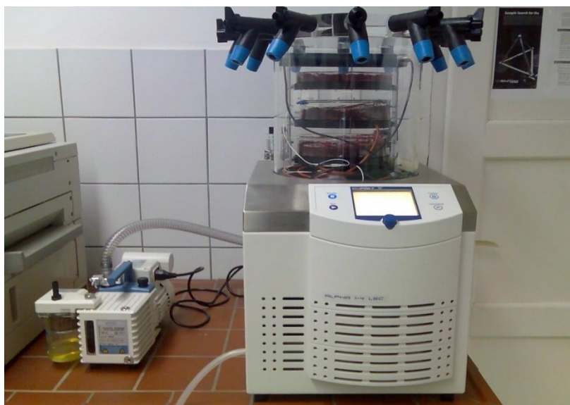
Slika 11 Liofilizator Alpha 1-4 LSC (Christ, Njemačka)
