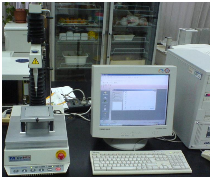
Slika 10 Teksturometar TA.XT (Stable Micro System, Velika Britanija)
