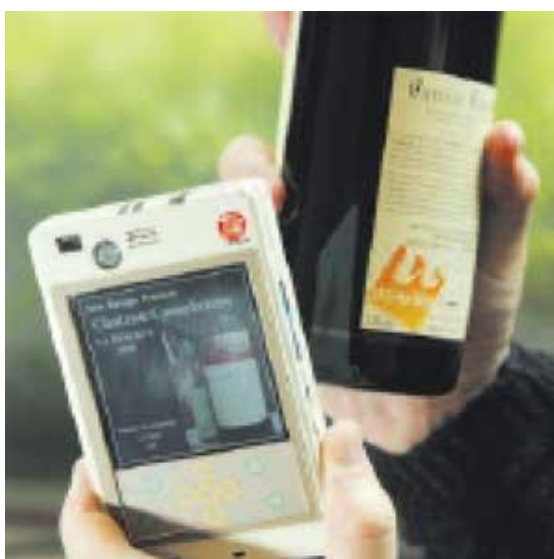
Slika 6. Sustav za očitavanje RFID tagova ( http://www.interempresas.net )
