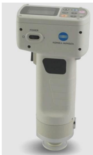
Slika 8 Kromametar Konica Minolta CR-300 (Tanasković, 2014)
