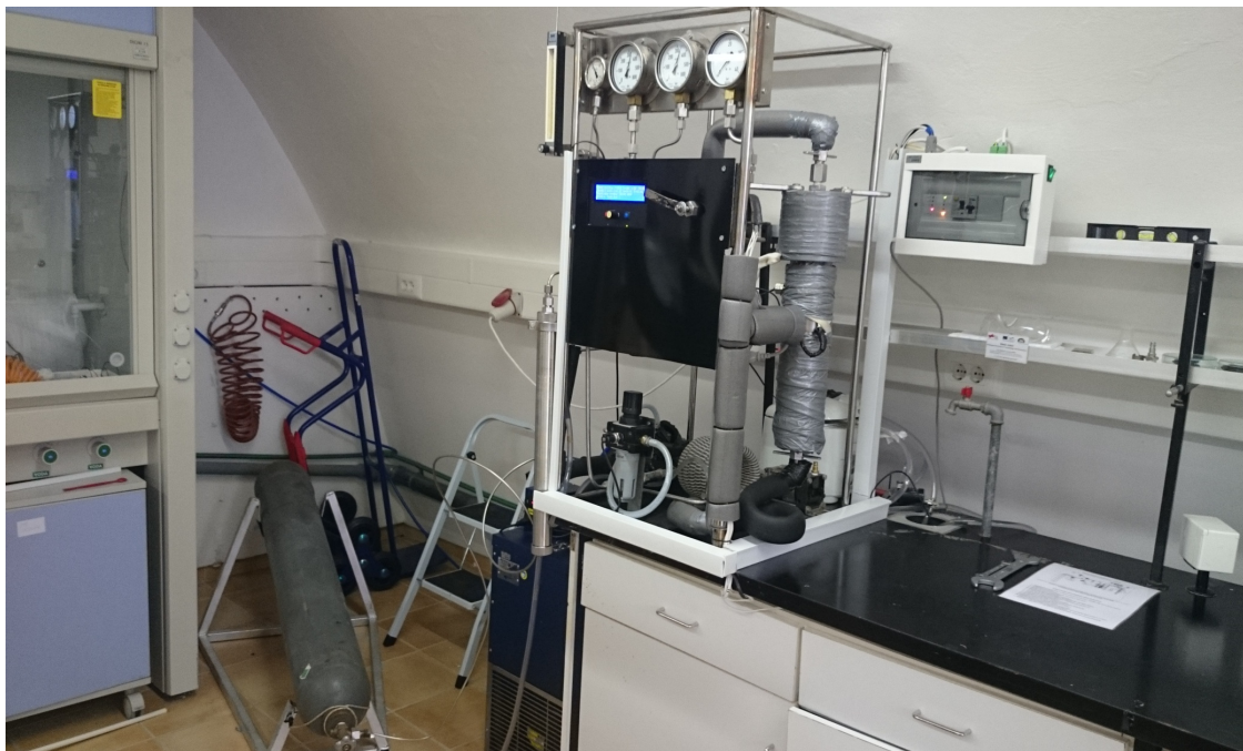
Slika 23. Uređaj za ekstrakciju superkričnim CO 2 (PTF, Osijek)
