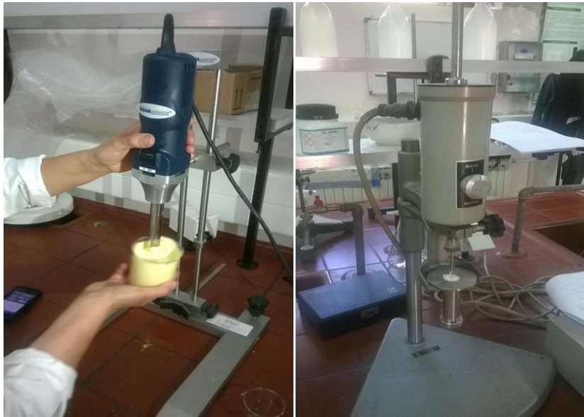
Slika 10. Laboratorijski homogenizator Wiggenshauser, model D-500 (Germany, Malaysia) i rotacijski viskozimetar Rheomat 15 T
