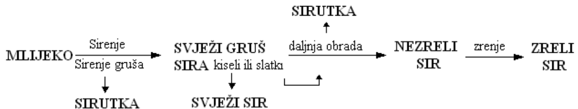
Slika 1 Shematski prikaz proizvodnje sira (1)
