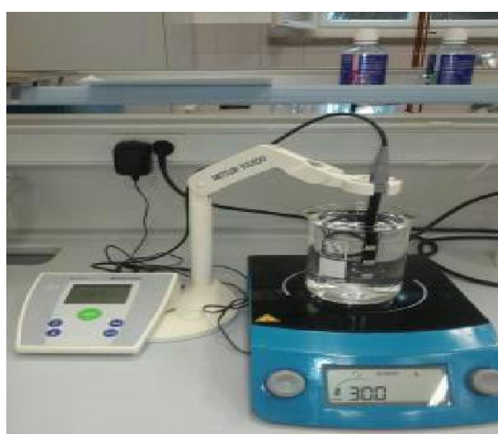
Slika 14 pH metar „Seven easy“
