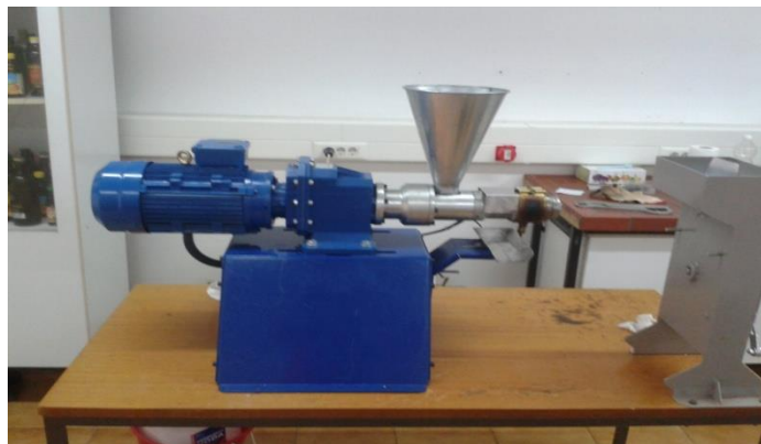
Slika 7 Pužna preša kojom smo proizvodili ulje iz koštice marelice
