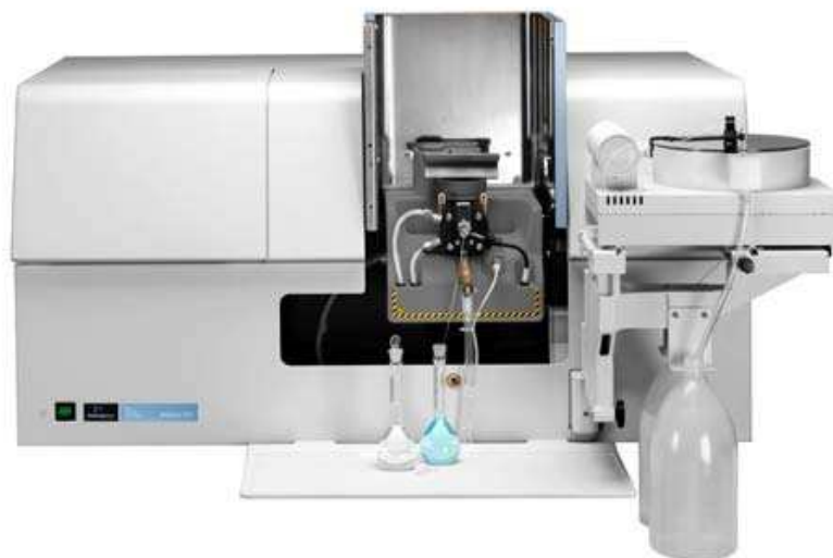
Slika 19b. Atomski apsorpcijski spektrometar „Perkin-Elmer AANALYST 600“.
