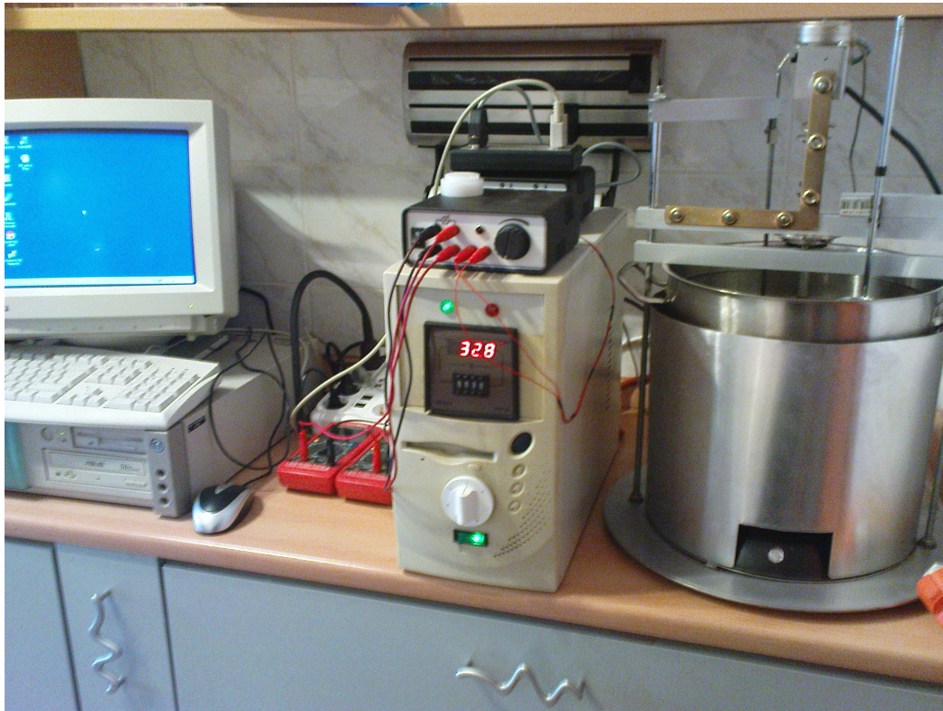
Prilog 2. Fotografija uređaja za određivanje koeficijenta toplinske vodljivosti metodom s pravocrtnim izvorom topline (PIT).
